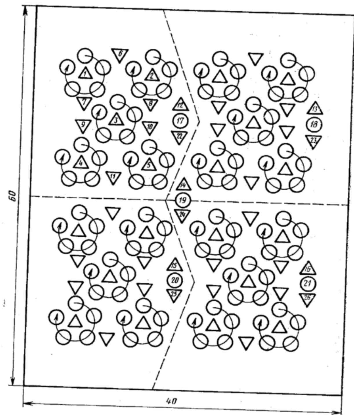
На данной схеме треугольники обозначают отпечатки, наносимые образцовым наконечником, а кружки — поверяемыми наконечниками. Отпечатки поверяемых наконечников расположены по окружности на одинаковом расстоянии от находящегося в центре отпечатка образцового наконечника. Порядок нанесения отпечатков каждым из поверяемых наконечников на всех окружностях должен быть одинаков. Так, например, первый и последний поверяемые наконечники соответствуют началу и концу круговых стрелок.
