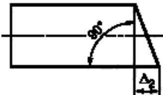
Косину реза ( $\Delta_2$ ) измеряют металлическим угольником по ГОСТ 3749—77, лежащим одной стороной на плоскости расположения слитка, и измерительной линейкой по ГОСТ 427—75. Измерение косину реза проводят на двух торцовых плоскостях.
