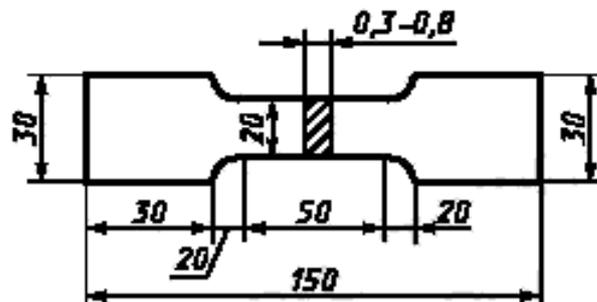
Скорость передвижения активного захвата машин при растяжении образцов должна быть 10—15 мм/мин.
